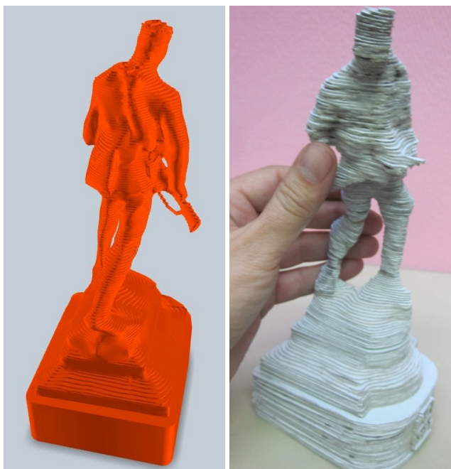
3Д модел и реплика добијена лепљењем слојева
